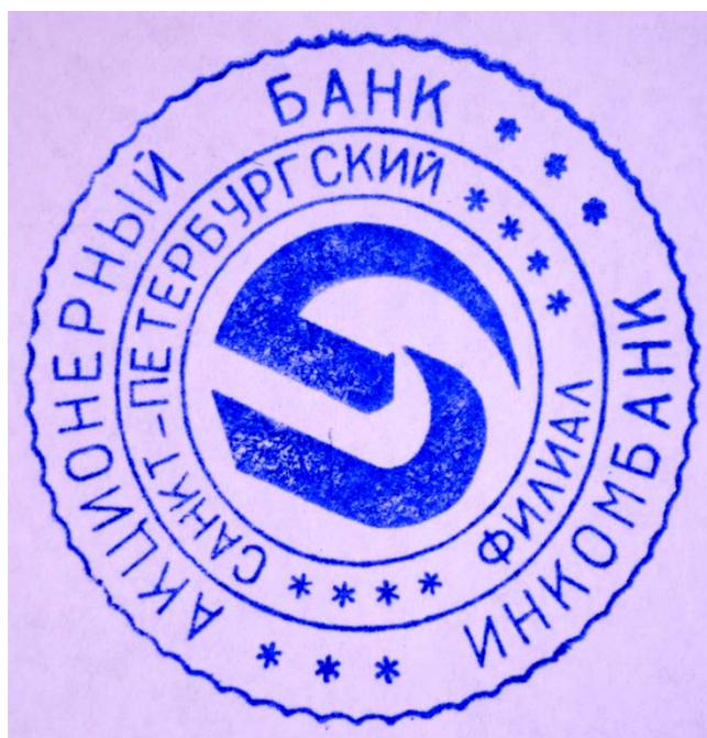
Рис. 36. Оттиск печатной формы, изготовленной способом вулканизации в матрице, выполненной путём механического гравирования
