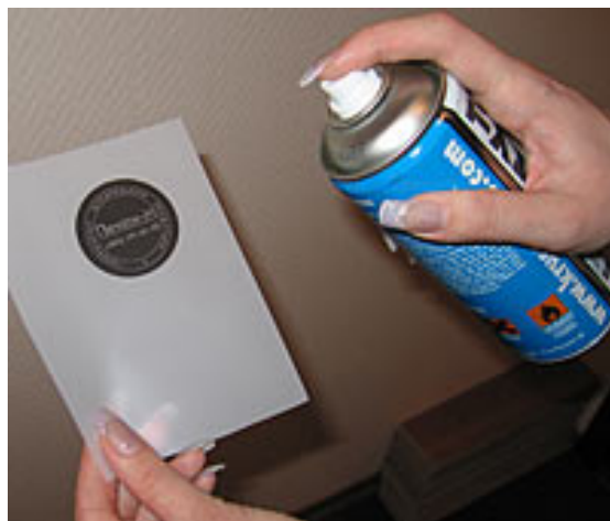
Рис. 44. Обработка распечатанного негатива аэрозольным затемнителем
