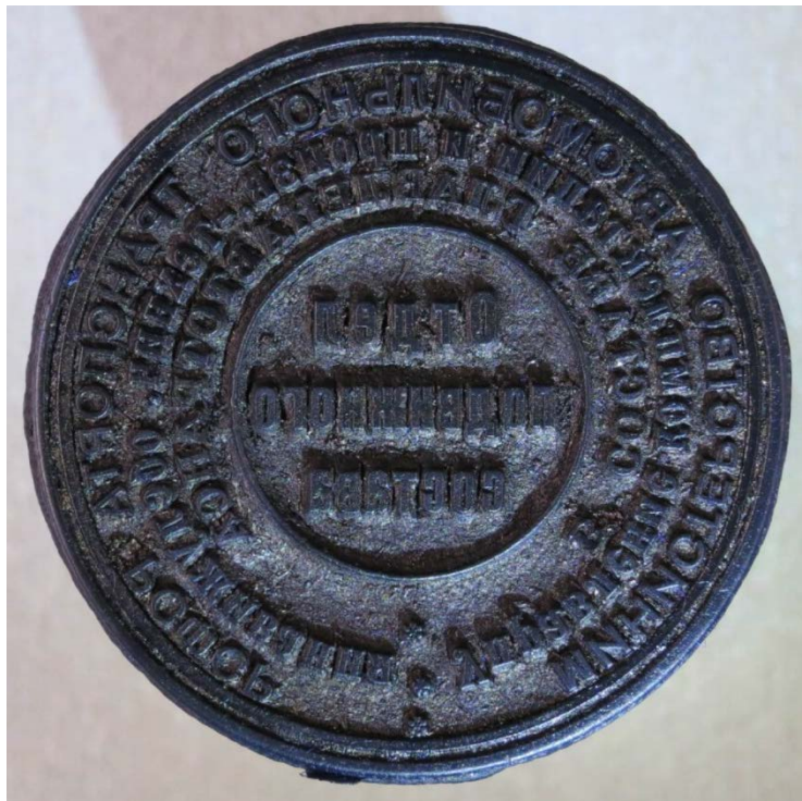
Рис. 32. Печатная форма высокой печати, изготовленная способом вулканизации в матрице, выполненной с набора типографского шрифта
