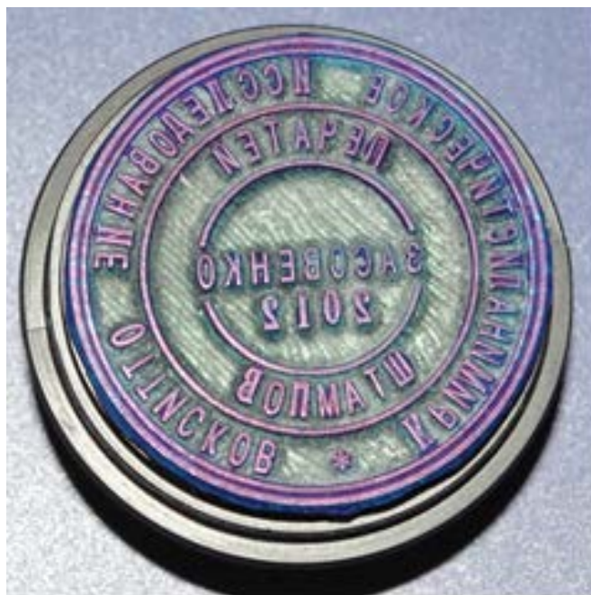
Рис. 69. Форма высокой печати, изготовленная путём восстановления по оттиску самонаборной печати, выполненная по фотополимерной технологии
