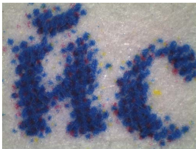
Рис. 62. Фрагмент оттиска печати, выполненный способом электрофотографической печати с помощью цветного знаковосинтезирующего печатающего устройства, работающего с оцифровкой изображения
