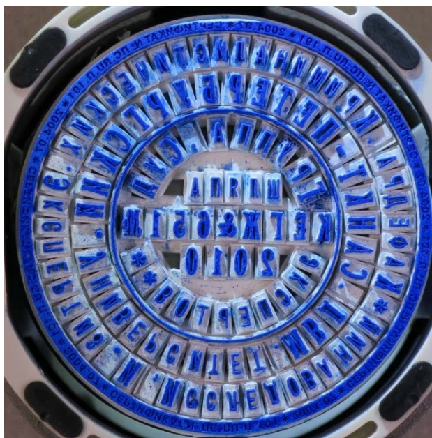
Рис. 42. Самонаборная форма высокой печати, состоящая из элементарных печатных форм, изготовленных способом вулканизации резины с матриц
