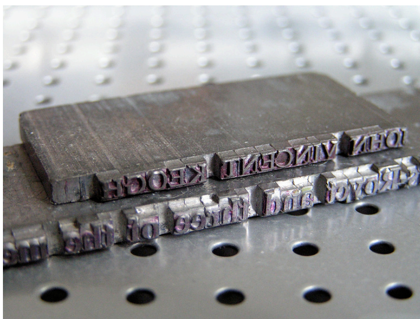
Рис. 30. Отлитые строки линотипного набора
