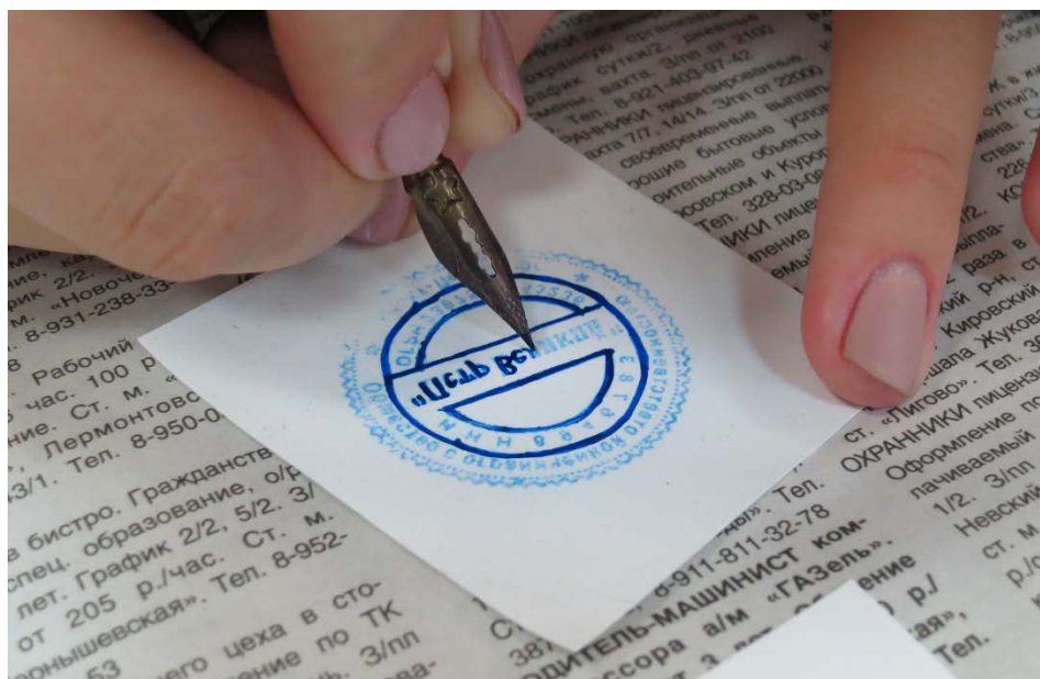
Рис. 66. Усиление откопированного оттиска печати — получение плоской рисованной печатной формы
