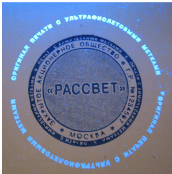
Рис. 91, 92. Оттиск печати с химическими метками. Слева – при обычном освещении, справа — в ультрафиолетовых лучах
