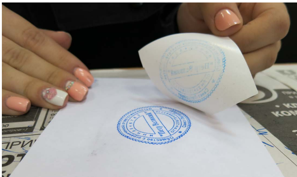
Рис. 65. Копирование оттиска печати на фотобумагу — получение плоской печатной формы
