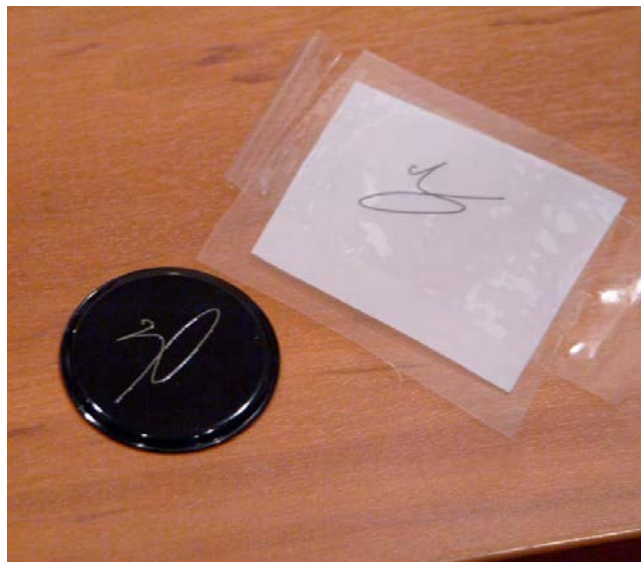
Рис. 55. Готовая печатная форма и фотоформа после экспонирования в флэш-установке
