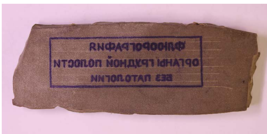
Рис. 64. Плоская рисованная печатная форма прямоугольного штампа, изготовленная из фрагмента резинового полотна
