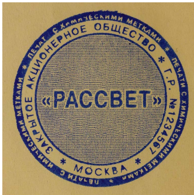
Рис. 84. Оттиск печати, содержащий скрытое изображение
