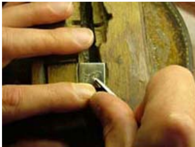
Рис. 20. Процесс ручного гравирования
