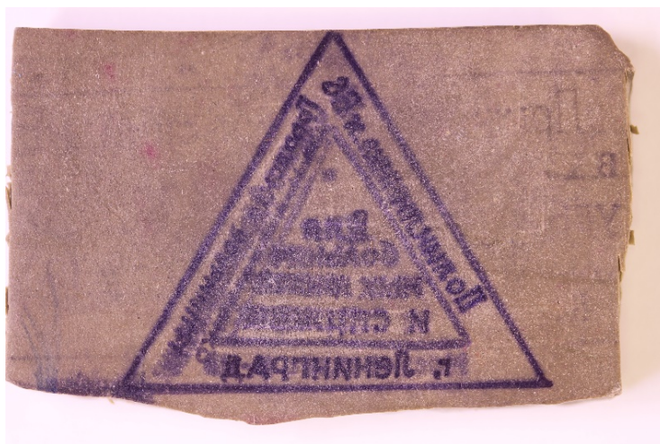
Рис. 63. Плоская рисованная печатная форма треугольной печати, изготовленная из фрагмента резинового полотна
