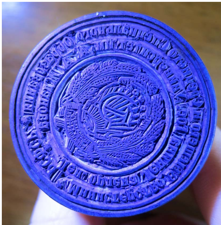
Рис. 22. Печатная форма, изготовленная способом ручного гравирования (вырезания)
