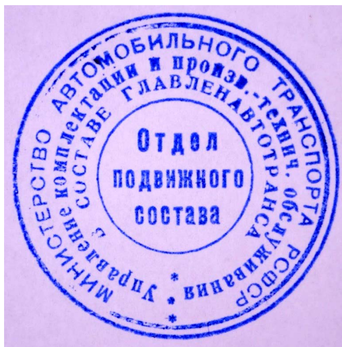
Рис. 33. Оттиск формы высокой печати, изготовленной способом вулканизации в матрице, выполненной с набора типографского шрифта
