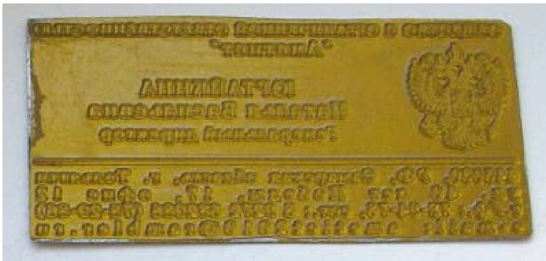
Рис. 37. Форма (пуансон), изготовленный из твёрдого фотополимера
