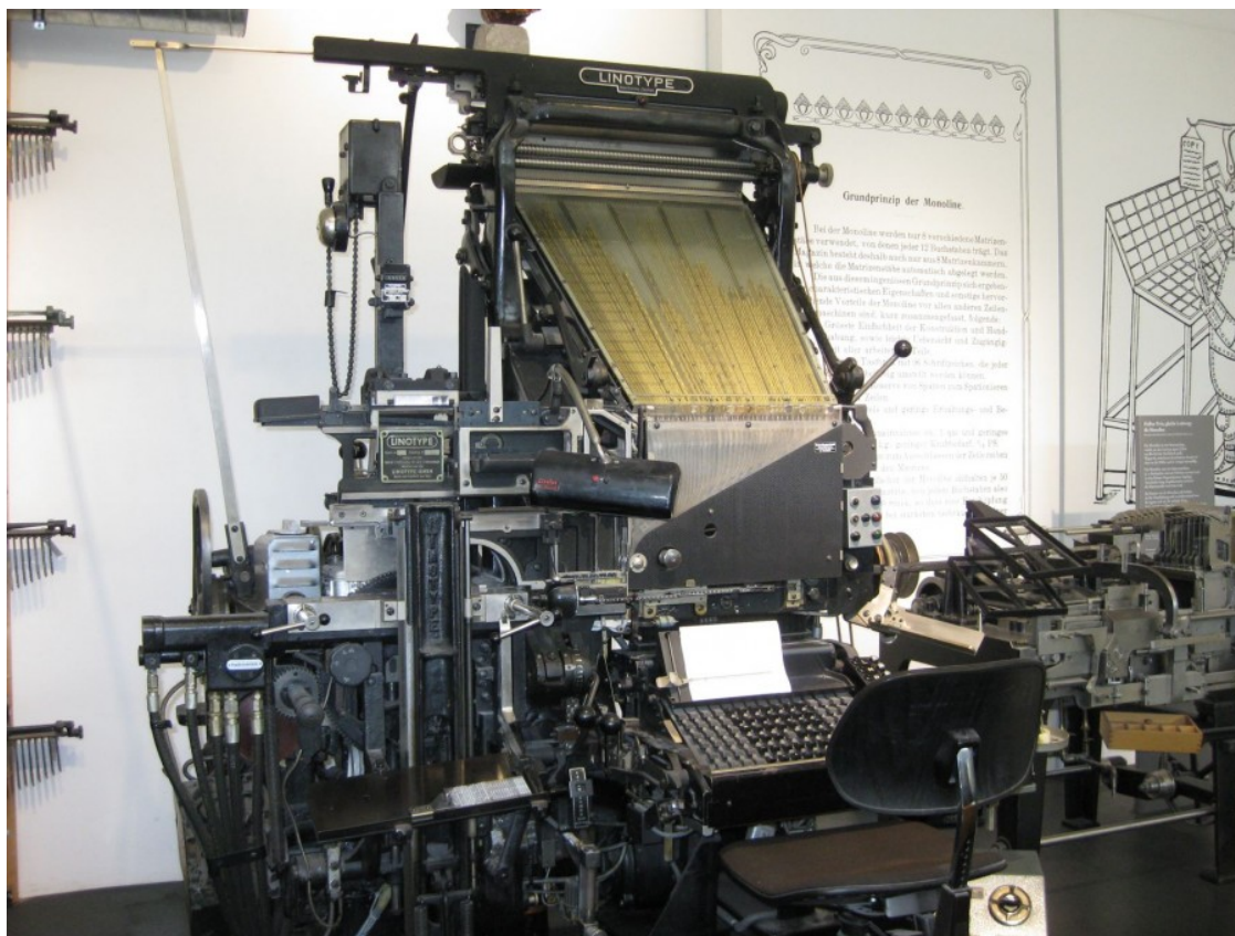
Рис. 31. Линотип — строкоотливная машина
