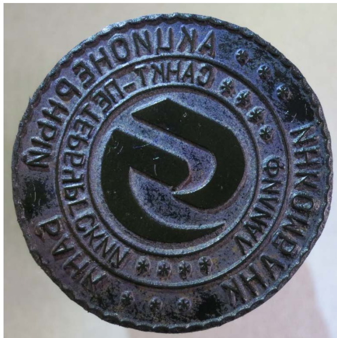
Рис. 35. Форма высокой печати, изготовленная способом вулканизации в матрице, выполненной путём механического гравирования
