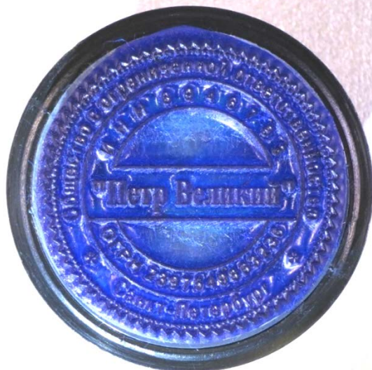
Рис. 49. Форма высокой печати, изготовленная фотомеханическим способом с использованием фотополимерного материала
