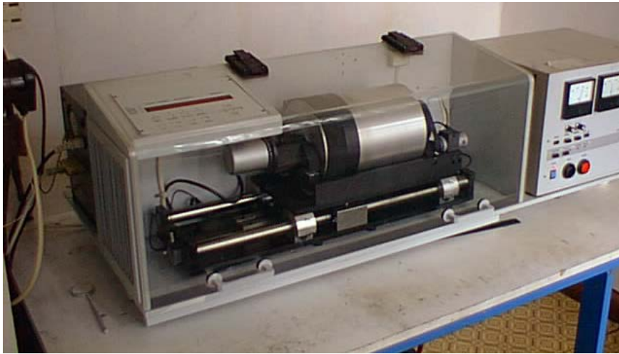
Рис. 24. Барабанный лазерный гравер
