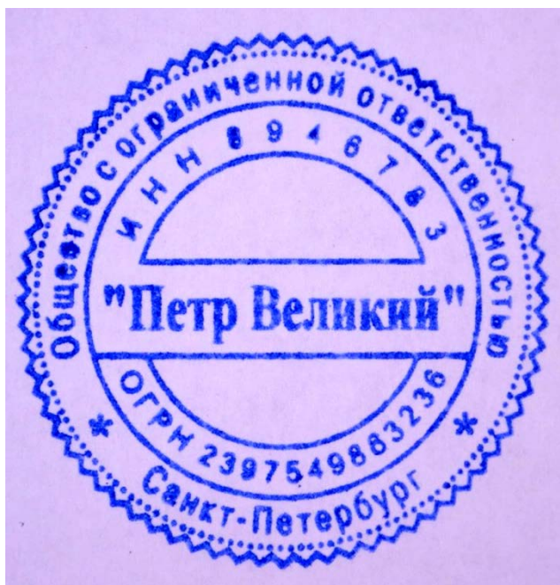
Рис. 50. Оттиск печатной формы, изготовленной способом вулканизации с матрицы, выполненной путём механического гравирования
