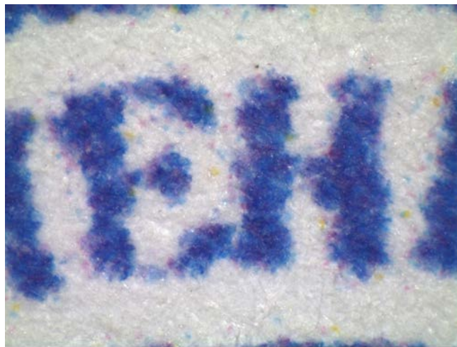
Рис. 61. Фрагмент оттиска печати, выполненный способом капельно-струйной печати с помощью цветного знаковосинтезирующего печатающего устройства
